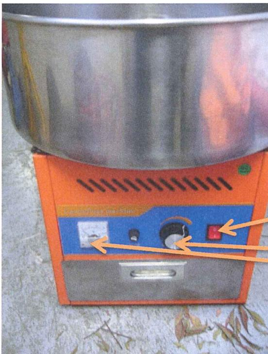
1 : Mettre la machine à chauffer pendant 5 minutes (la toupie centrale tourne)
